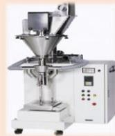
各種原料および製品を、一定の質量に分割して袋、缶、箱などの容器に充てん（ランダムな質量を取捨選択して目的の質量にするタイプもある）。
